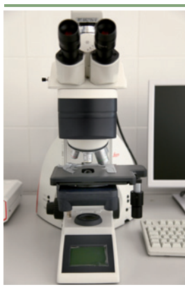
Fluorescenčný mikroskop DM4000 (Leica Microsystems) – plne automatický mikroskop s motorizovanými časťami pre cytogenetickú analýzu, vhodný aj pre FISH, mFISH a CGH analýzy. K prístroju patrí aj zariadenie pre vyhodnocovanie karyotypov a FISH analýzu s digitálnou kamerou.
