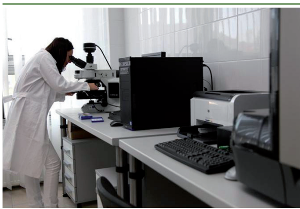
Fluorescenčný mikroskop DM4000 (Leica Microsystems) – plne automatický mikroskop s motorizovanými časťami pre cytogenetickú analýzu, vhodný aj pre FISH, mFISH a CGH analýzy. K prístroju patrí aj zariadenie pre vyhodnocovanie karyotypov a FISH analýzu s digitálnou kamerou.
